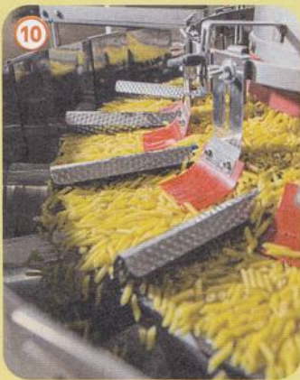
10 Die fertigen Nudeln laufen über ein Transportband zur Waage. Sie wiegt die Menge aufs Gramm genau ab.
