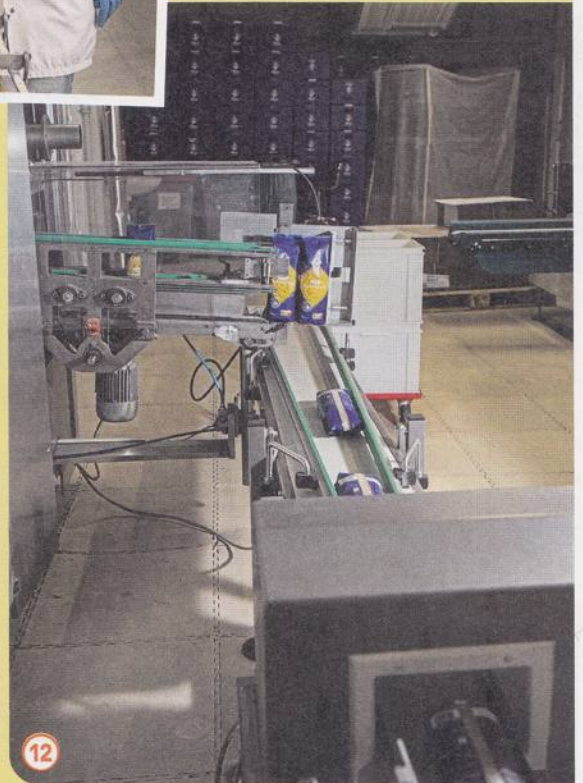
12 Die Packungen laufen durch einen Metalldetektor. Er kontrolliert, ob etwas darin ist, was nicht hineingehört, etwa Schrauben oder Metallspäne, die sich von einer Maschine gelöst haben könnten.
