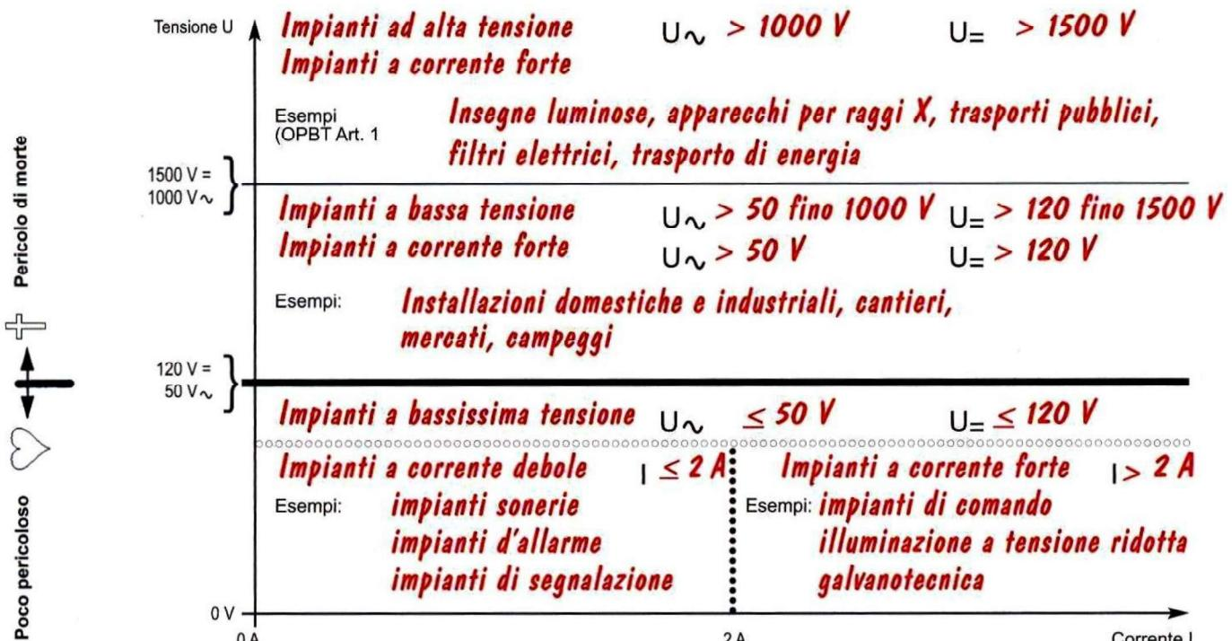
**Indicazione:** tutti gli impianti, anche quelli con tensioni inferiori a 50 V AC o 120 V DC possono, in determinate circostanze, essere pericolosi per persone o cose!
