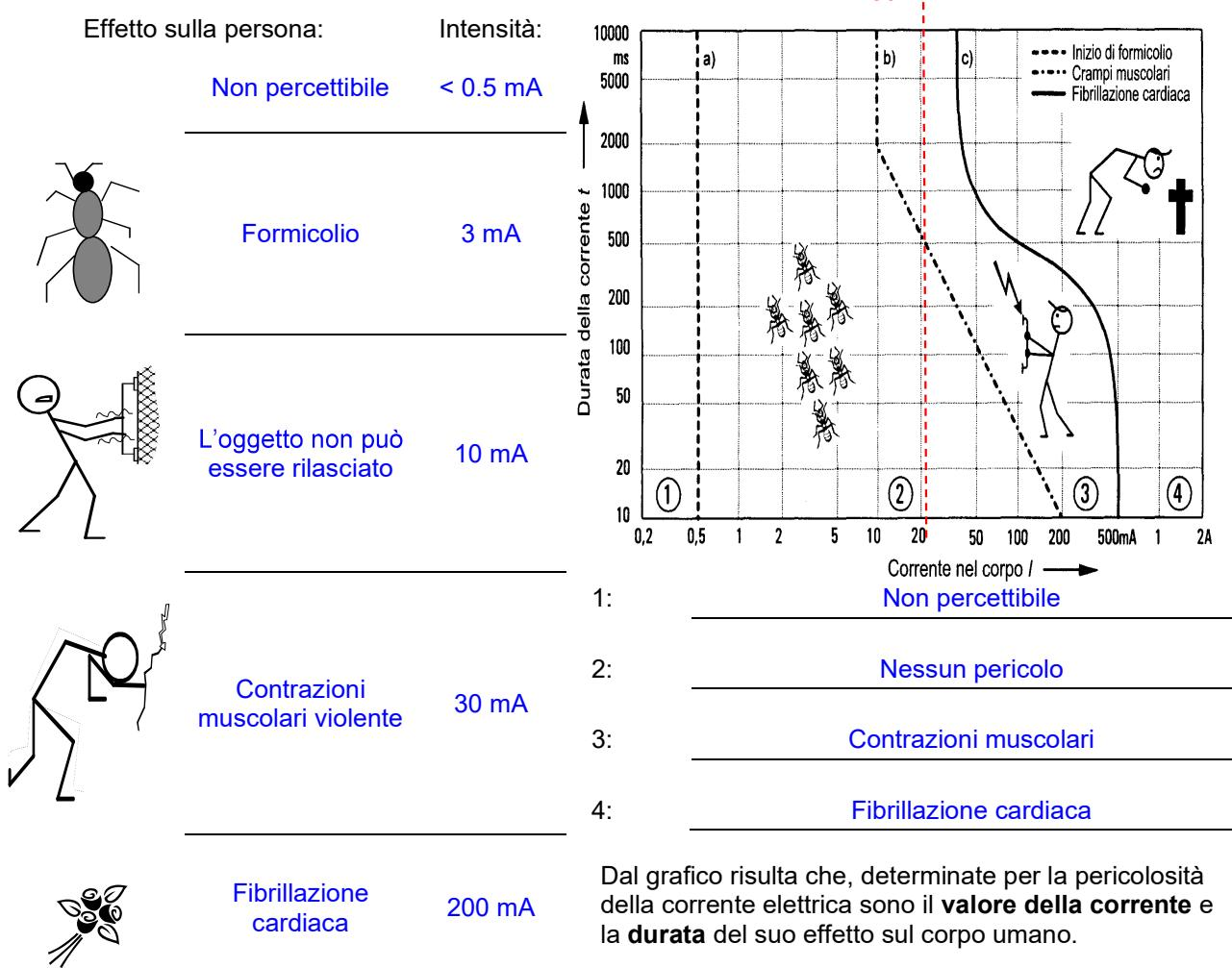
Calcola, se una persona viene a contatto con una tensione di 230V, quanta corrente scorre nel suo corpo.
