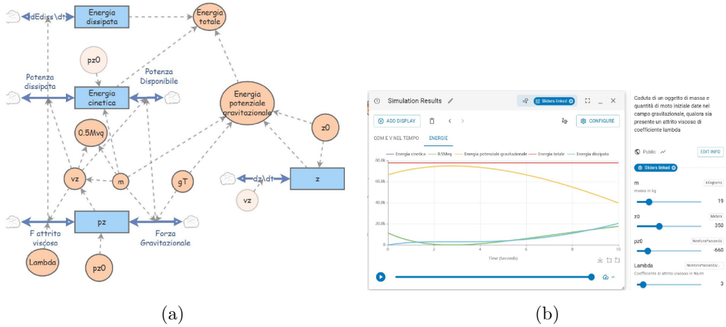
Figura 2.10: Modello completo della caduta in un mezzo viscoso: 2.10(a): modello con controllo dell'conservazione dell'energia totale; 2.10(b): bilancio dell'energia. Modello disponibile a https://insightmaker.com/insight/6A64kx6iFyNvGFgAVnONHA .
